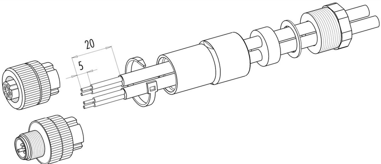
Material der Gewinderinge: Kunststoff, Zink Druckguss, Edelstahl
