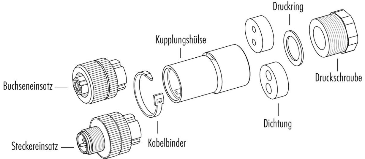
Material der Gewinderinge: Kunststoff, Zink Druckguss, Edelstahl
